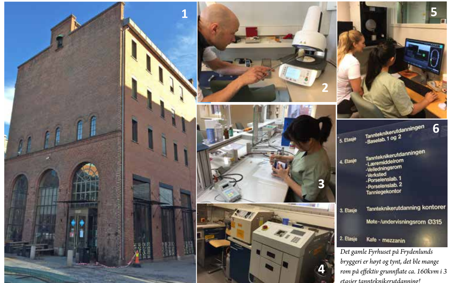
2. Ansvarlig for de tanntekniske laboratoriene Terje Nilsen i aksjon: Helkeramet e-max, også kalt Lithium –disilikat, blir delvis framstilt i disse ovnene under varme og trykk. 3. En Student jobber med å framstille en helprotese.
